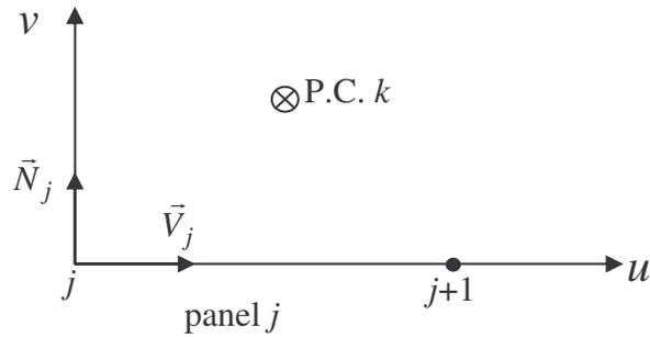
$$\vec{V}_j = \frac{\bar{x}_{j+1} - \bar{x}_j}{l_j}, \quad l_j = \text{longitud del panel}$$
