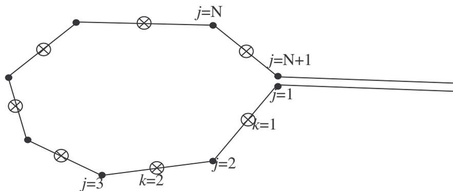
Como puntos de control se toman los puntos medios de cada panel. Así, si la posición de los nodos es  $(x_j, z_j)$ , la de los puntos de control será:
