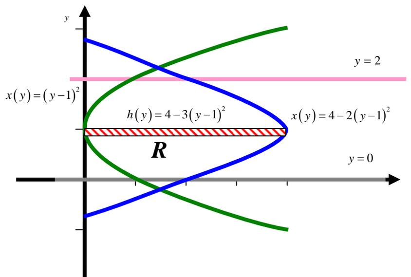
b) Volumen obtenido al girar la región alrededor del eje  $OX$ , aplicando el método de tubos.
