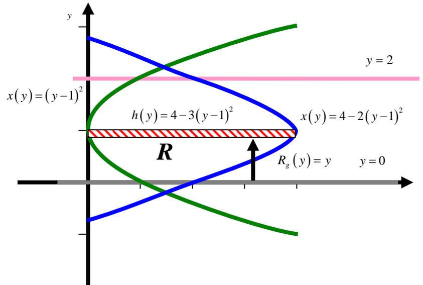
c) Volumen obtenido al girar la región alrededor del eje  $OY$ , aplicando el método de discos.
