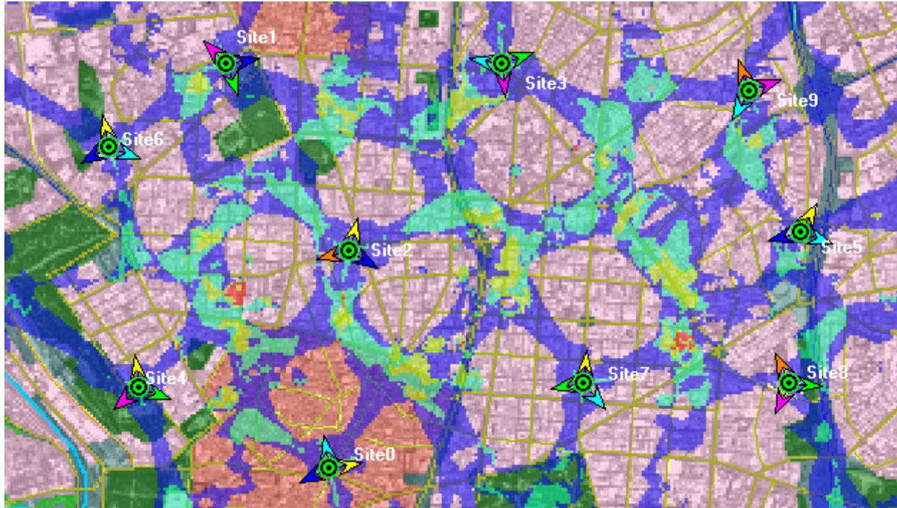
“Polución” del canal piloto (basada en la carga de tráfico obtenida en la simulación)
