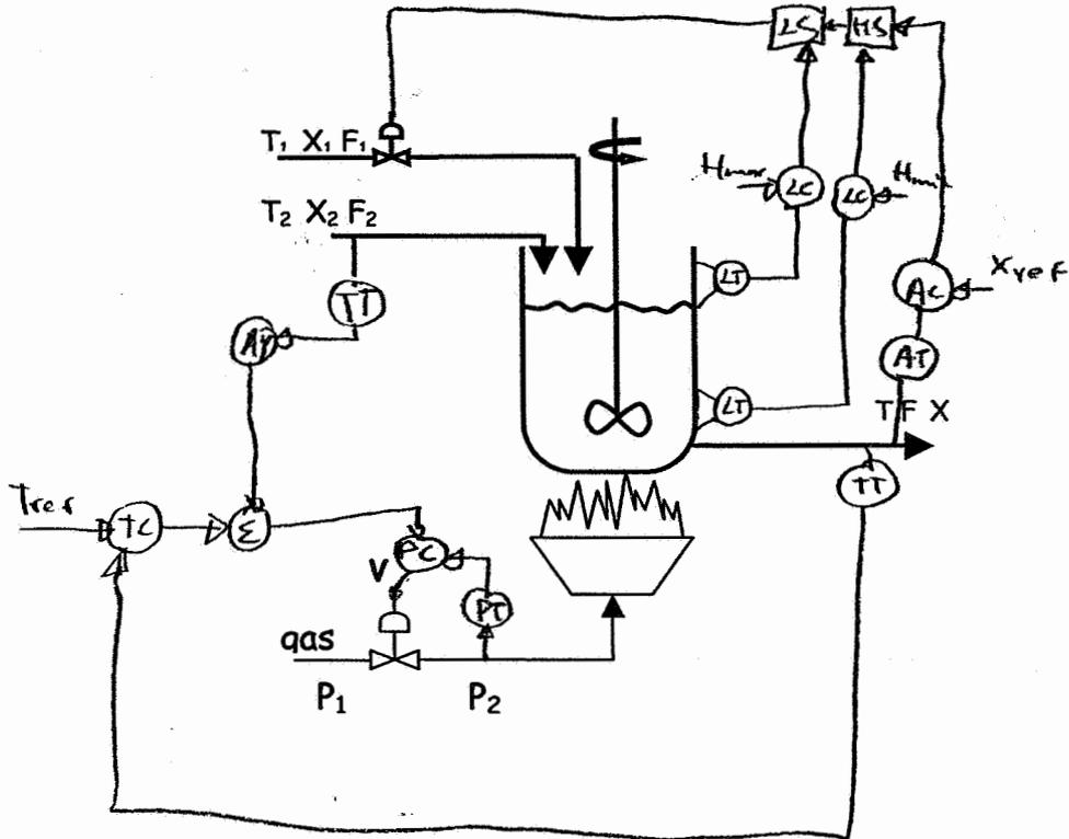
b) Dibujar el diagrama de bloques correspondiente al control de la temperatura T propuesto en el apartado anterior
