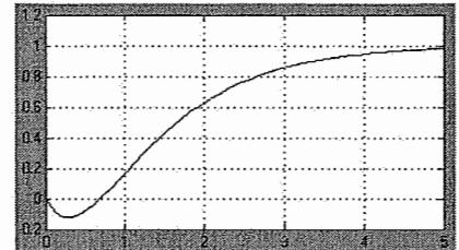
Para efectuar su control se intenta una estructura con realimentación de la salida y se utiliza un controlador calculado a partir de las tablas de Ziegler-Nichols con los siguientes valores leídos de forma aproximada de la figura de la derecha:  $K_p=1, t_m=0,7 t_p=1,3$ . La estructura de control obtenida resulta ser inestable, por lo que se pide:
