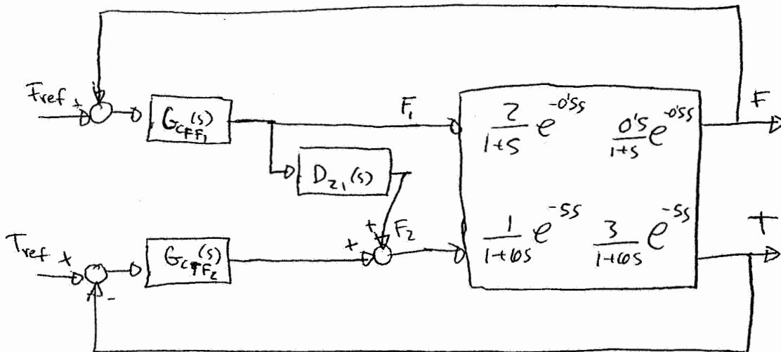
b2) Calcular todas las funciones de transferencia de dicha estructura de control.
