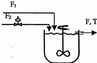
$$\begin{bmatrix} F \\ T \end{bmatrix} = \begin{bmatrix} e^{-5s}/(15s+1) & e^{-5s}/(15s+1) \\ -0.07e^{-15s}/(20s+1) & 0.63e^{-15s}/(20s+1) \end{bmatrix} \begin{bmatrix} F_1 \\ F_2 \end{bmatrix}$$
