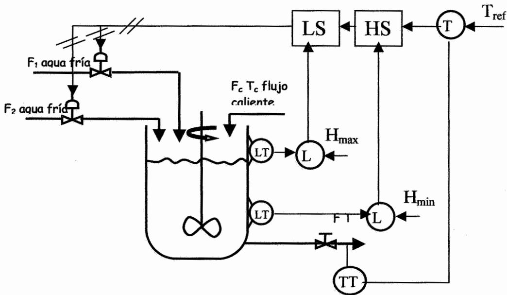
Dibujar en sendos diagramas la evolución de las aperturas de ambas válvulas de agua fría en función de la temperatura de salida (supóngase que en este proceso no se superan los niveles máximo y mínimo de altura del depósito)
