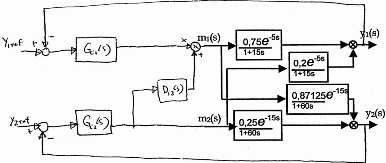
Calcular los valores de todas las funciones de transferencia involucradas en la anterior estructura de control.
