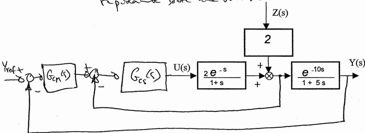
Sistema 3: El control anticipativo no tiene sentido, puesto que la perturbación afecta rápidamente a la salida y la salida en cambio tarda mucho. - El control en cascada aporta muy poca ventaja puesto que la variable intermedia repercute casi instantáneamente sobre la salida
