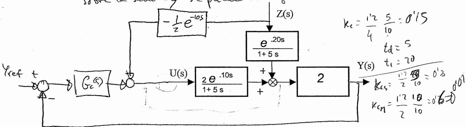
Sistema 2: Control en cascada, puesto que la perturbación influye repentinamente sobre una variable intermedia medible
