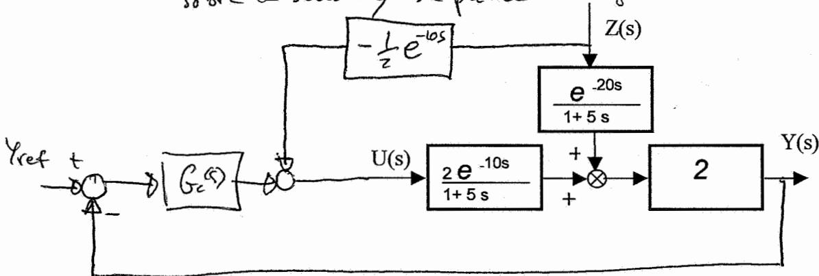
Sistema 2: Control en cascada, puesto que la perturbación influye rápidamente sobre una variable intermedia medible
