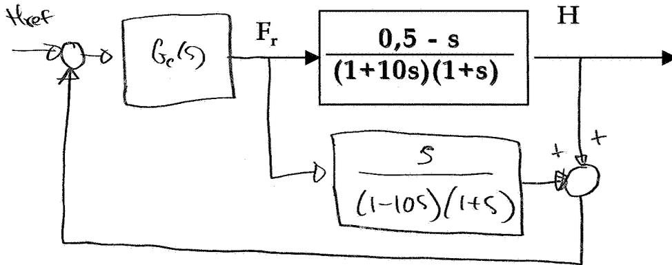
7 Diseñar y calcular un controlador adecuado del nivel de agua en el depósito.
