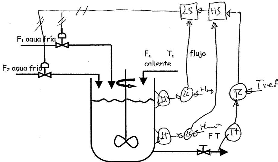
b) Dibujar en sendos diagramas la evolución de las aperturas de ambas válvulas de agua fría en función de la temperatura de salida (supóngase que en este proceso no se superan los niveles máximo y mínimo de altura del depósito)
