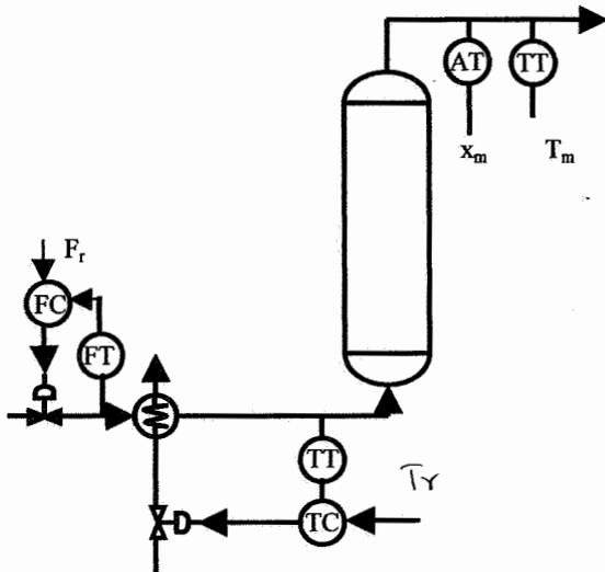
$$\begin{bmatrix} T_m(s) \\ x_m(s) \end{bmatrix} = \begin{bmatrix} \frac{-3.4 e^{-1.93}}{1.15s+1} & \frac{1.1 e^{-3.70}}{0.14s+1} \\ \frac{2.2 e^{-0.65}}{1.34s+1} & \frac{-0.8 e^{-1.15}}{1.27s+1} \end{bmatrix} \begin{bmatrix} F_r(s) \\ T_r(s) \end{bmatrix}$$
