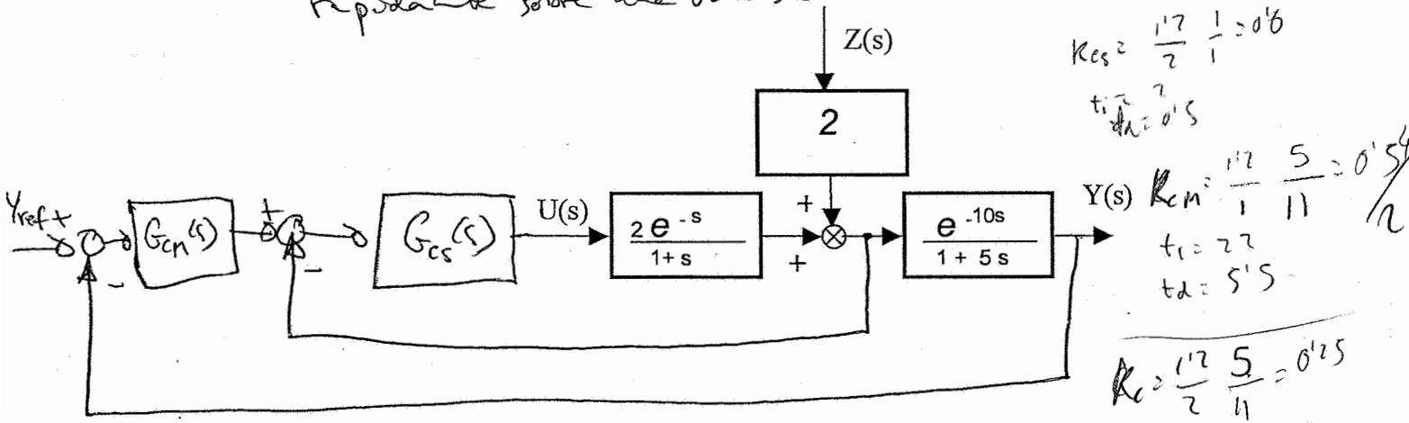
Sistema 3: El control retroactivo no tiene sentido, puesto que la perturbación afecta repentinamente a la salida y la mide en cambio todo mundo. - El control en cascada aporta muy poca ventaja puesto que la variable intermedia repercute casi instantáneamente sobre la salida
