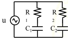
$$\begin{bmatrix} \dot{u}_{c1} \\ \dot{u}_{c2} \end{bmatrix} = \begin{bmatrix} -\lambda_1 & 0 \\ 0 & -\lambda_2 \end{bmatrix} \begin{bmatrix} u_{c1} \\ u_{c2} \end{bmatrix} + \begin{bmatrix} \lambda_1 \\ \lambda_2 \end{bmatrix} u$$
