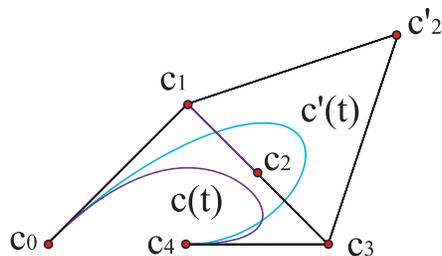
Figura 5: Control local: al mover el vértice  $c_2$ , se deforma mayormente la parte más próxima a él
