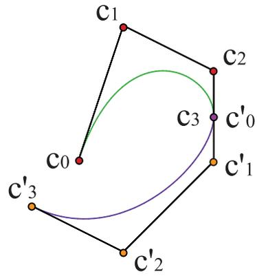
Figura 16: Los segmentos  $\overline{c'_0 c'_1}$ ,  $\overline{c_2 c_3}$  deben ser paralelos para que la curva compuesta tenga tangente continua
