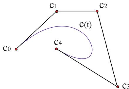
Figura 15: Los segmentos  $\overline{c_0c_1}$ ,  $\overline{c_3c_4}$  proporcionan las tangentes en  $c_0$  y  $c_4$ , respectivamente
