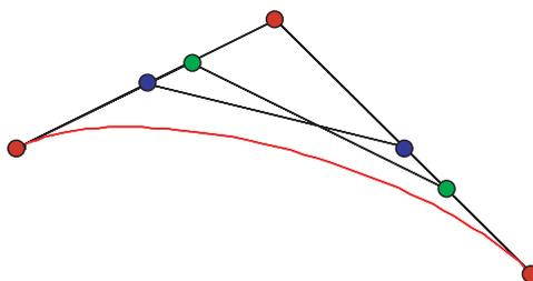
Figura 3.3: Distintas maneras de elevar el grado de una cónica
