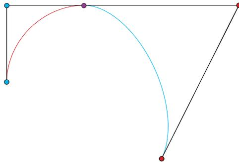
Figura 3.4: Curva compuesta con tangente continua
