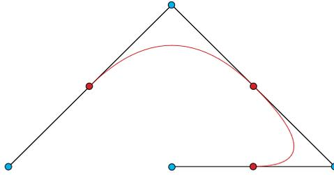
Figura 4.2: Spline parabólico de dos tramos
