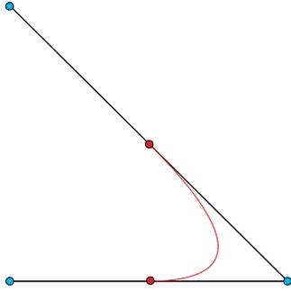
Figura 4.1: Spline parabólico de un único tramo
