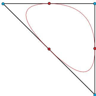
Figura 4.4: Spline cerrado parabólico
