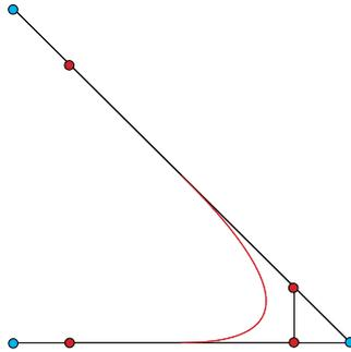
Figura 4.3: Elevación del grado de un spline parabólico
