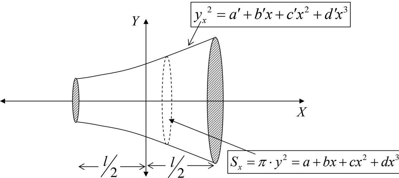
Así pues, el volumen real de un sólido de revolución definido por una función polinómica de hasta tercer grado será:
