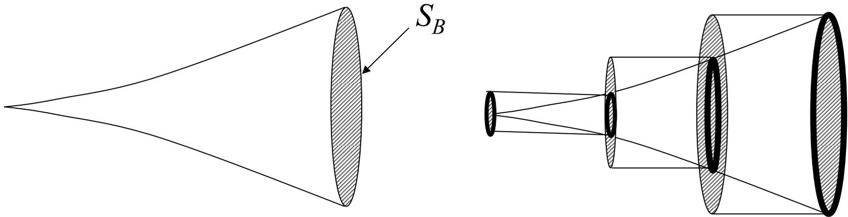
En el límite de las posibles divisiones, obtendríamos el volumen real por integración de cilindros infinitesimales, del sólido de revolución.
