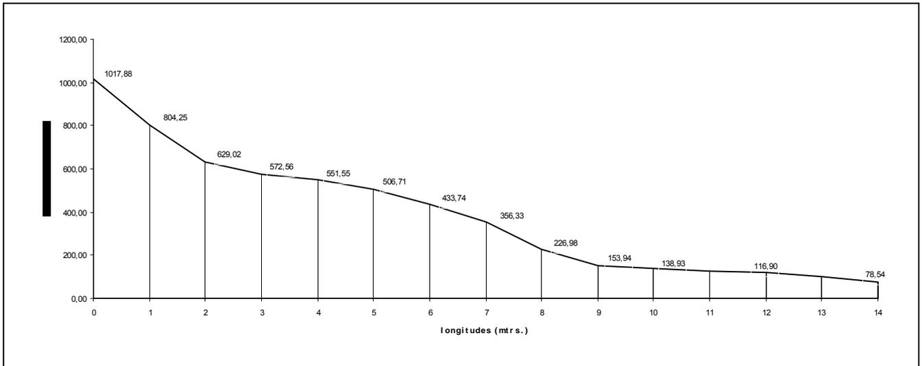
Tendremos así que la superficie, delimitada por la evolución de la línea de perfil de las secciones y los ejes de coordenadas, es equivalente al volumen del fuste
