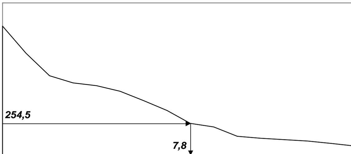
Tendremos así que el  $V_{Pressler \text{ Base}} (\text{dm}^3) = \frac{2 \pi}{3 \cdot 4} \cdot 3,6^2 \cdot 7,8 = 529,30 \text{ dm}^3$
