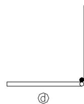
VARIANTE DE COLOCACION EN EL CASO DE EMPLEARSE DOS ARMADURAS DE ESPERA POR CADA BARRA PRINCIPAL DEL PILAR.
