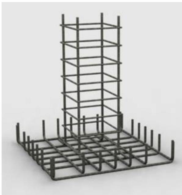
Fig. 1 Armadura de una zapata
