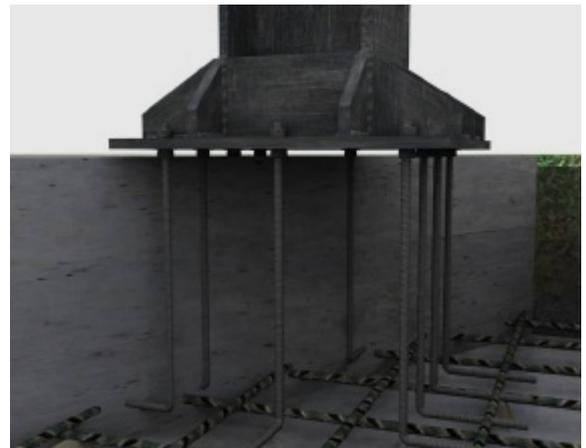
Fig. 5 Zapata para pilar de hierro
