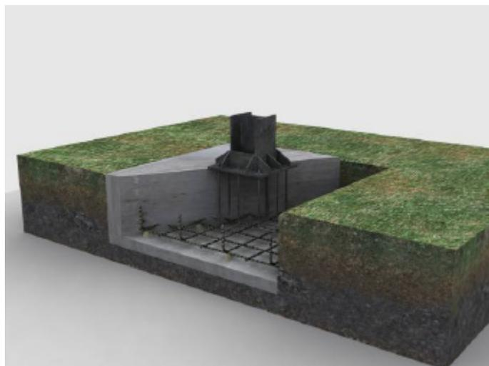
Fig. 6 Zapata para pilar de hierro
