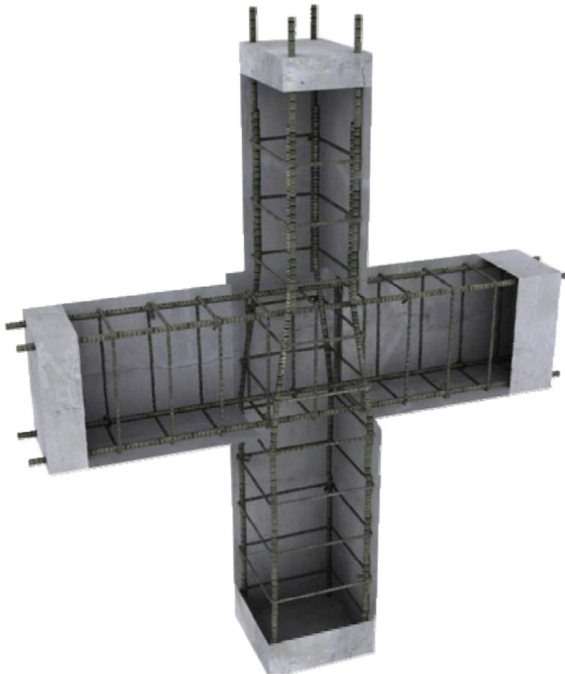
Fig. 71 Nudo interior en planta intermedia
