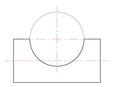
Determinar las proyecciones horizontal y vertical del sólido formado al restarle al cilindro de eje horizontal el de eje vertical
