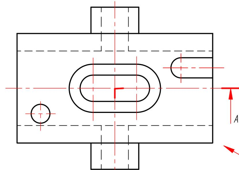
Dadas las vistas, dibujad la perspectiva isometrica de acuerdo al punto de vista indicado en A3 a escala 2:1. No se tendrá en cuenta el coef. de reducción isométrico. La pieza debe ir cortada de acuerdo al plano A-A.
