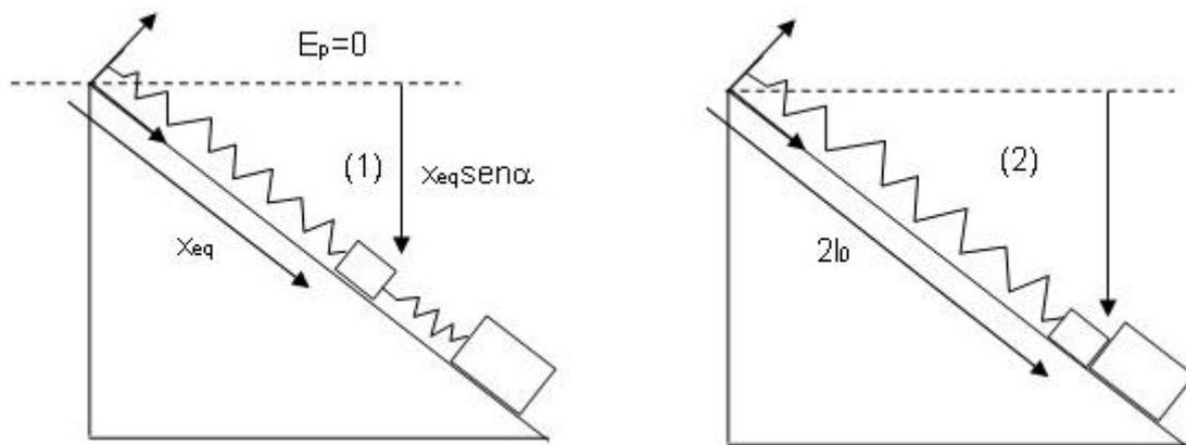
De esta manera la energía potencial gravitatoria de la masa  $m$  será negativa. Para que llegue a la posición de  $M$  sin chocar debe llegar con velocidad nula.
