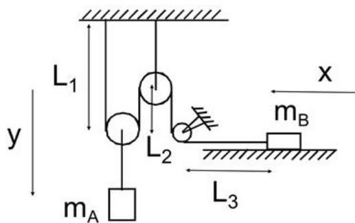
La posición  $y$  de la masa A aumenta al aumentar la longitud  $L_1$  y la posición  $x$  de la masa B disminuye al aumentar la longitud  $L_3$ :
