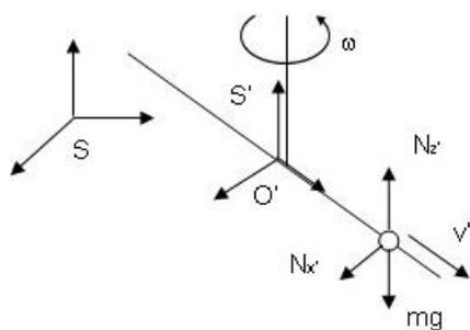
En este caso no existe aceleración angular  $\vec{\alpha} = 0$  y  $\vec{\omega} = \omega\vec{k}'$  constante (recuérdese que al ser el giro antihorario en torno al eje  $\vec{k}'$ , el giro es positivo). Además al colocar  $S'$  en el eje de giro  $\vec{a}_{O'} = 0$ .
