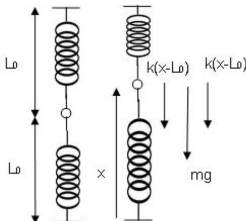
$$\ddot{x} + \frac{2k}{m}x = \frac{2kd}{m} \text{ (Ecuación diferencial del M.A.S.)}$$
