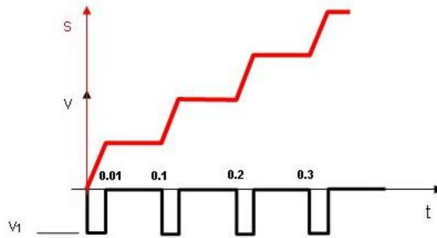
En la gráfica se muestra la velocidad en negro (curva de diente de sierra) y el espacio recorrido por la plataforma en rojo (curva de escalera) con tramos de subida lineales debidos a la velocidad constante.
