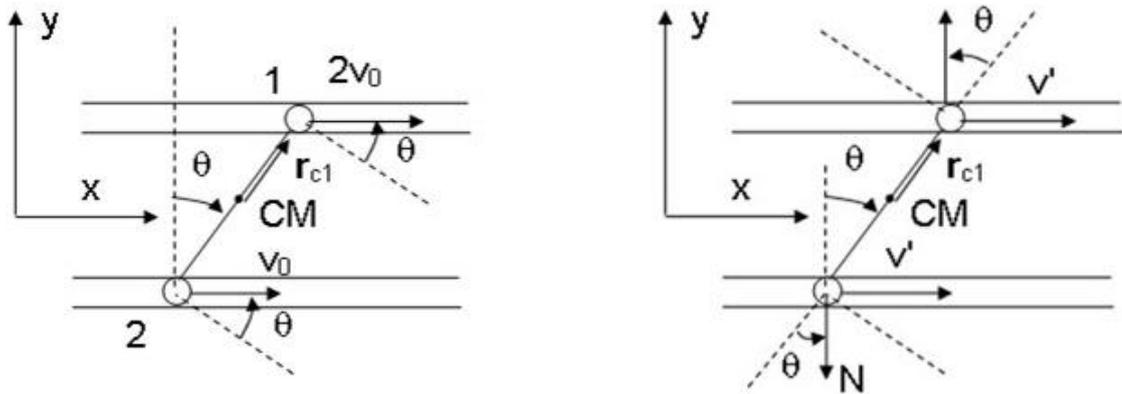
El CM del sistema se encuentra en la mitad del hilo por simetría. Eligiendo un eje con origen en la masa 2 y dirección y sentido el del hilo hacia la masa 1 se tendría  $d_{CM} = \frac{1}{2m}(Lm+0m) = \frac{L}{2}$ .
