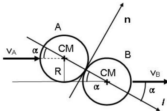
Sea  $\vec{n}$  la dirección normal a la dirección de la línea de choque. Según la dirección normal  $\vec{n}$  cada bola conserva su velocidad y, por tanto, su cantidad de movimiento después de la colisión es:
