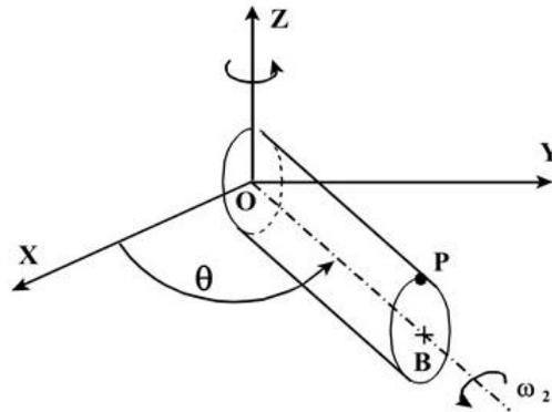
Al mismo tiempo, el cilindro gira en torno a su eje con velocidad angular constante  $\omega_2$  en el sentido que se indica.
