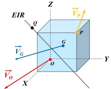
La recta que define el eje instantáneo de rotación (EIR) en ese instante, -el punto Q es un punto genérico de esa recta-, viene dada por:
