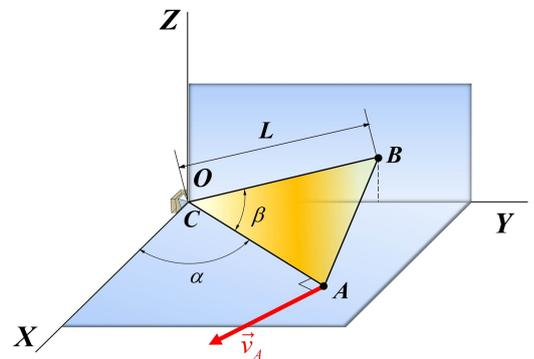
Sabiendo que en el instante de interés  $t^*$ , el ángulo que forma el lado  $CA$  de la placa con el eje  $X$  es  $\alpha = 60^\circ$ , ¿cuánto vale en ese instante la velocidad angular de la placa,  $\vec{\omega}(t^*)$ ?
