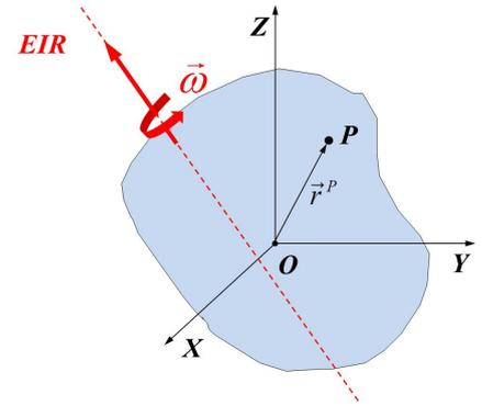
siendo  $R$  y  $\omega$  constantes positivas. En el movimiento del sólido, el eje instantáneo de rotación y mínimo deslizamiento (EIRMD), en el instante  $t_0 = \pi/(2\omega)$ , está definido por:
