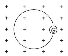
Si en un campo magnético uniforme colocamos una espira rígida y estacionaria, vemos que por ella no pasa corriente ninguna ya que el galvanómetro no la detecta.
