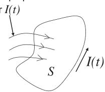
En un circuito aislado, rígido y estacionario la variación del flujo se debe solo a la variación con el tiempo de la intensidad que lo recorre
