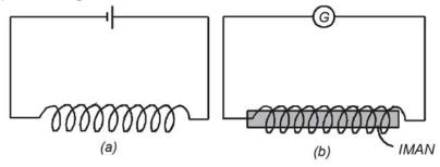
Por el galvanómetro del circuito (b) no pasa corriente. Al introducir o sacar el imán del solenoide, se observa una corriente en el galvanómetro (intensidad inducida) que cesa cuando cesa el movimiento del imán.
