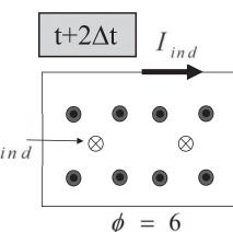
El flujo aumenta  $(d\phi/dt > 0)$ , la densidad de corriente intensidad se opone al dl
