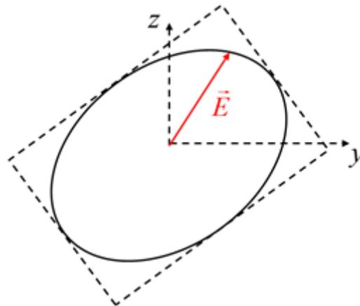
**Figura 10.4:** Onda electromagnética plana con polarización elíptica propagándose en el eje  $\vec{i}$ .
