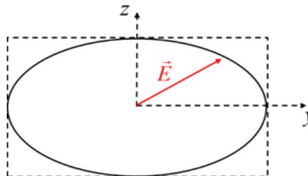
**Figura 10.6:** Onda electromagnética plana correspondiente a la polarización elíptica centrada en ejes propagándose en el eje  $\vec{i}$ .
