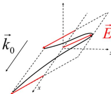
**Figura 10.3:** Onda electromagnética plana linealmente polarizada que se propaga en el eje  $\vec{i}$ . La figura representa únicamente el campo eléctrico. La proyección del campo en cualquier punto sobre el plano OYZ es un segmento de recta.
