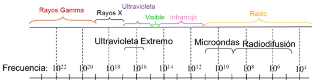
**Figura 10.2:** Clasificación de las ondas electromagnéticas según la frecuencia  $\nu$ .
