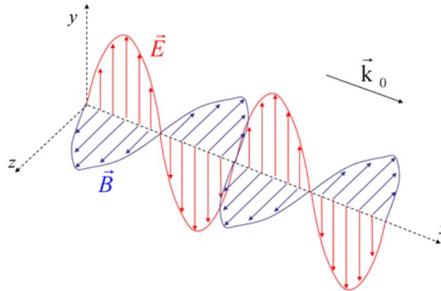
**Figura 10.1:** Onda electromagnética plana monocromática con  $\vec{k}_0 = k_0 \vec{i}$ .
