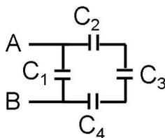
Calcular la capacidad equivalente entre los puntos  $A$  y  $B$  del sistema de condensadores de la figura, siendo  $C_1 = C_2 = C_4 = 1 \text{ pF}$  y  $C_3 = 2 \text{ pF}$ .
