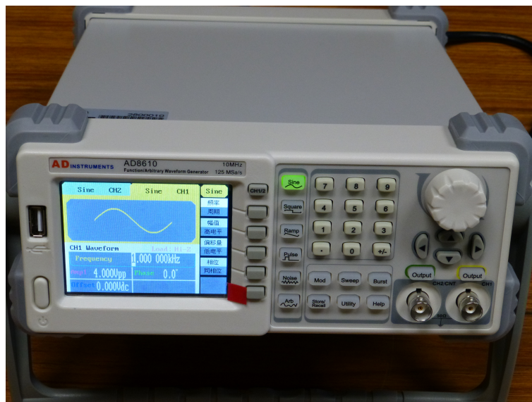
Figura 1.12: Generador de funciones utilizado en el Laboratorio
