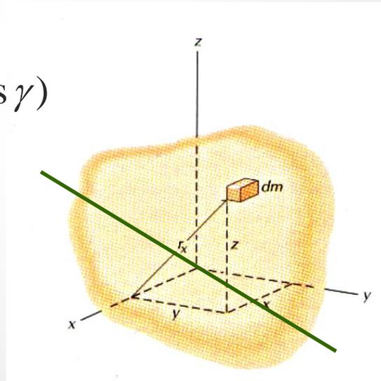
$$I_0 = \begin{bmatrix} \cos \beta & \cos \alpha & \cos \gamma \end{bmatrix} \begin{bmatrix} I_X & -I_{XY} & -I_{XZ} \\ -I_{XY} & I_Y & -I_{YZ} \\ -I_{XZ} & -I_{YZ} & I_Z \end{bmatrix} \begin{bmatrix} \cos \beta \\ \cos \alpha \\ \cos \gamma \end{bmatrix}$$
