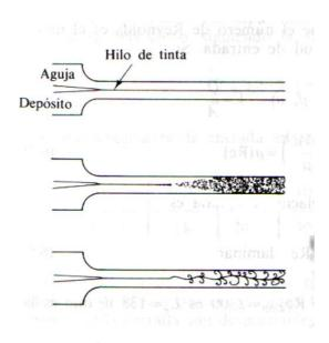
Experimento de Reynolds: a la entrada de una tubería se inyecta una tinta que tiene una densidad igual a la del agua. Cuando la válvula de salida está ligeramente abierta, la tinta se moverá a través del tubo de vidrio de forma intacta formando un filamento. Sin embargo, a medida que se abre la válvula se alcanza una condición en la cual la tinta asume un movimiento fluctuante a medida que avanza en la tubería.
