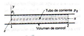
Examinemos el flujo entre las secciones 1 y 2 de la tubería. Supongamos también que no hay cambio en el perfil de velocidades, de modo que el cociente  $\frac{V^2}{2}$  tiene el mismo valor en las secciones 1 y 2. Teniendo en cuanto todo esto la primera ley de la Termodinámica para el volumen de control compuesto por la región interior de la tubería entre las secciones 1 y 2, esto es la ley puede expresarse como:
