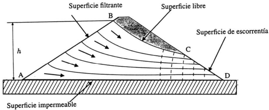
Con objeto de evitar esta perforación se colocan drenes (un drenaje es un recinto muy permeable respecto del propio terreno) como se muestra en la figura que hacen que la superficie libre esté siempre por debajo de la superficie externa de la presa, en este punto se controla que la tierra no pase al mismo mediante rejillas o filtros de tamaño de poro adecuado.
