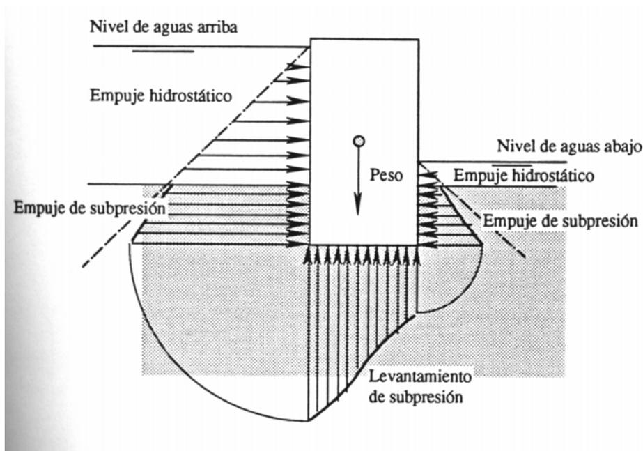
Para amortiguar el efecto de las subpresiones se instalan, cerca de la zona agua arriba, drenajes dentro de la presa desde la base de la misma a una galería de desagüe a un nivel superior al nivel agua abajo. Este mismo sistema se utiliza en losas grandes, donde es preferible taladrar verticalmente el piso para aliviar el efecto de las subpresiones a evacuar el agua filtrada.
