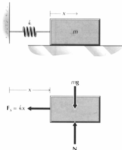
Aplicando al bloque la segunda ley de Newton, tenemos la ecuación diferencial del movimiento del bloque:
