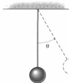
En general si son necesarias  $n$  variables para especificar completamente la posición de un sistema mecánico decimos que el sistema tiene  $n$  grados de libertad. Así por ejemplo, un disco que se moviera en el plano sin restricciones tendría tres grados de libertad, por una parte los desplazamientos  $x$  e
