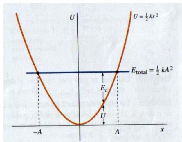
En la figura se ha representado la energía potencial en función de  $x$ . La energía total es constante y está representada por una línea horizontal. Esta línea corta a la curva de la energía potencial en  $x = A$  y  $x = -A$ . Éstos son los puntos en los que los objetos, en su oscilación, cambian el sentido de la
