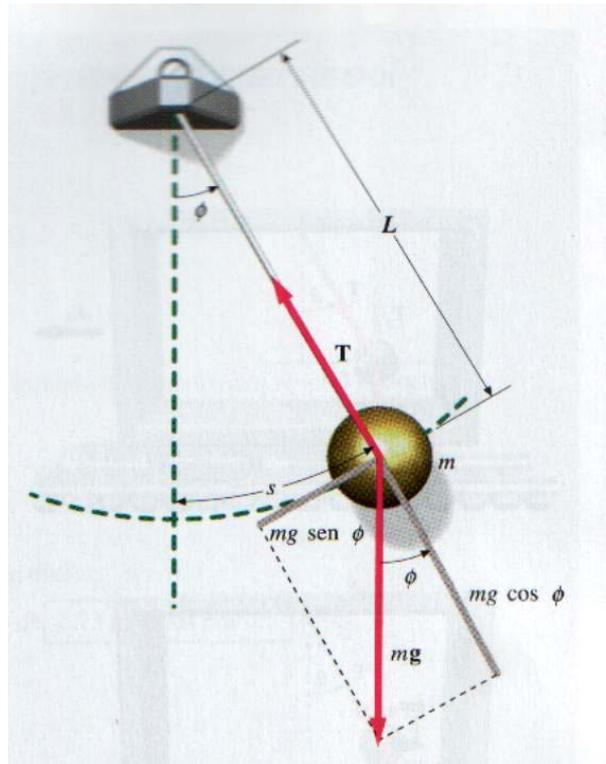
Las fuerzas que actúan sobre la masa son su peso  $mg$  y la tensión  $T$  de la cuerda. Cuando la cuerda forma un ángulo  $\phi$  con la vertical, para la componente tangencial del peso la segunda ley de Newton nos da:
