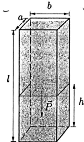
**Problema 12.** Una barra prismática de sección cuadrada con una longitud  $L$  se encuentra fija al plano  $XY$  y sometida a tensiones en la dirección del eje  $OZ$  tales que  $\varepsilon_z(z) = a(1 - \frac{z}{L})$  donde  $a$  es una constante positiva. Determinar el tensor de tensiones y de deformaciones referido a los ejes dados.
