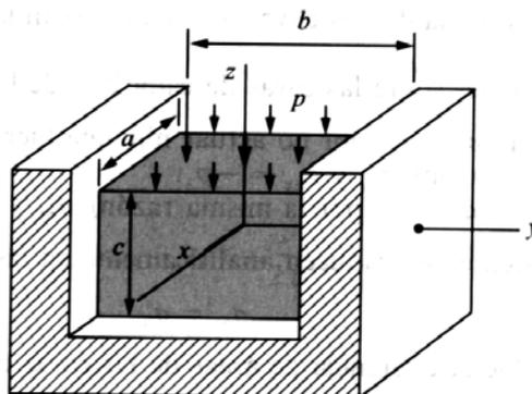
**Problema 8.** Dos paralelepípedos iguales del mismo material y dimensiones  $a \times b \times c$ , se colocan a uno y otro lado de una placa rígida adosados a ella por sus caras  $a \times c$ , de tal forma que sus ejes de simetría
