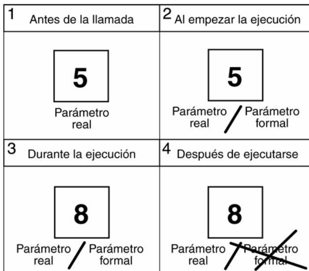
Figura 24. Utilización de la memoria al ejecutar una rutina con un parámetro formal variable
