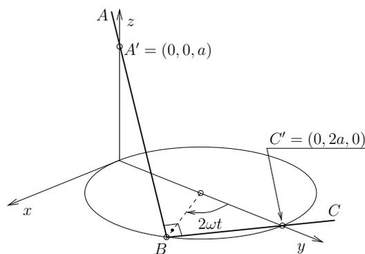
1. Velocidad angular de la varilla  $BC$  en su movimiento plano; velocidad de los puntos de la escuadra que coinciden sobre los puntos  $A'$  y  $C'$ .
