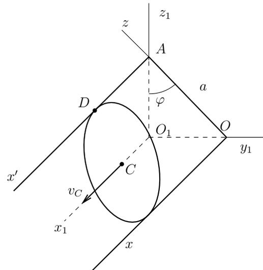
Un disco de diámetro  $a$  y centro  $C$ , que está contenido en todo momento en el plano móvil, rueda sin deslizar sobre la recta  $Ox$ , siendo conocida la velocidad de su centro  $v_C = v_C(t)$ . Se pide calcular en un instante genérico:
