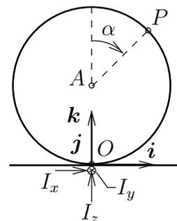
siendo  $\mathbf{I}'_O$  el tensor de inercia en  $O$  del nuevo sólido rígido formado por el aro y la partícula a él adherida. Otra forma de expresar el momento cinético después del impacto es  $(\mathbf{H}_O)_{\text{despues}} = \mathbf{I}_O \boldsymbol{\omega} + m \mathbf{OP} \wedge (\boldsymbol{\omega} \wedge \mathbf{OP})$ , que es totalmente equivalente a (3).
