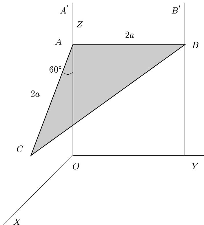
1.- Bajo la acción de la gravedad, la placa cae sin rotación, al no introducir las guías ningún impedimento. La altura inicial de  $C$  es  $z_C|_0 = a$ , luego la velocidad antes del choque es  $v_0 = \sqrt{2ga}$ .
