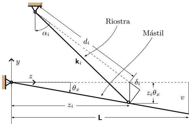
Para cables perpendiculares al eje del giro se tendrá:
