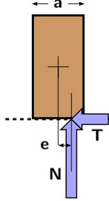
La reacción del suelo puede ser oblicua respecto a la vertical ( $T \neq 0$ ), pero no más que el ángulo de rozamiento. Si el ángulo de rozamiento entre sustentación y estructura es  $\rho$ , la razón  $T/N$  no puede superar al coeficiente de rozamiento:  $\mu = \tan \rho \geq T/N$ . Esto determina el valor máximo de **T** ( $\mu N$ ). Para sólidos indeformables, con los signos indicados, los *límites* son:
