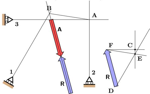
En el ejemplo, las reacciones en **1**, **2** y **3**, son, respectivamente, **DE**, **EC** y **CF**. Se obtienen como sigue: por **A** ha de pasar  $\vec{EC} + \vec{CF}$ , y también por **B**, lo que determina la dirección **AB**. Descomponiendo **R** según **AB** y **1B** se determina **E**. Solo queda descomponer **EF** para obtener **C**.
