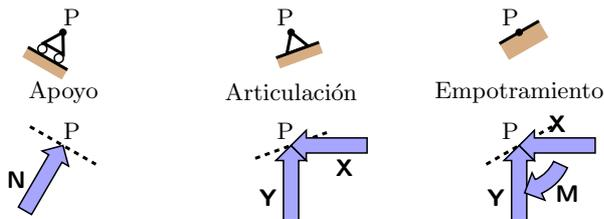
A pesar de su parecido con aparatos de apoyo reales, se **trata de constructos teóricos**: en particular, *las reacciones pueden tener sentido contrario al dibujado, y cualquier valor*. Las fuerzas representadas no son las únicas posibles, cualesquiera otras estáticamente equivalentes son válidas, a condición de que definan una, dos o tres variables independientes, según se trate de apoyo, articulación o empotramiento.
