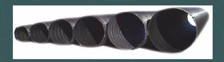
Plástico corrugado. Proporción de aberturas mínima 800 mm²/m. Longitud abertura 5 mm y ancho 0,5-2 mm. Ocupan 1-2% total superficie.
