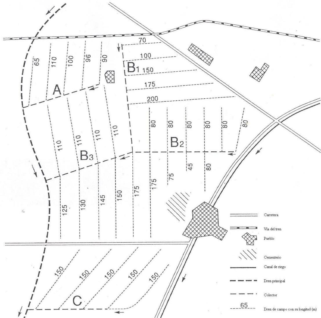
Figura 1. Esquema del sistema de avenamiento.
