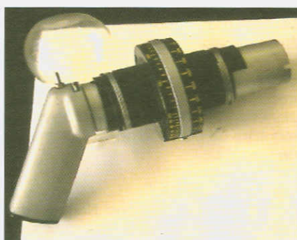
Arriba, Foto 1a: Vacuómetro analógico y Foto 1b: Vacuómetro digital
