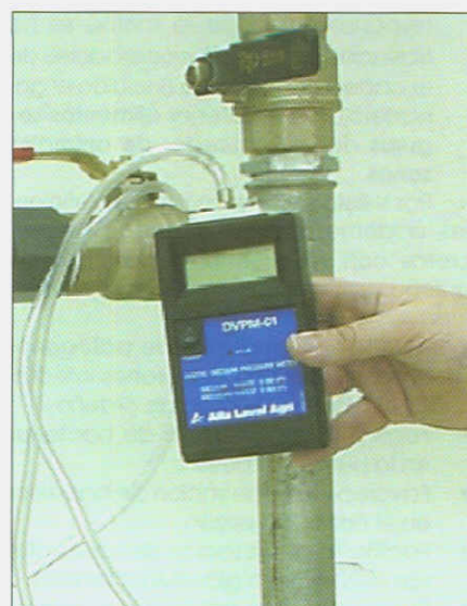
Arriba, Foto 1a: Vacuómetro analógico y Foto 1b: Vacuómetro digital
