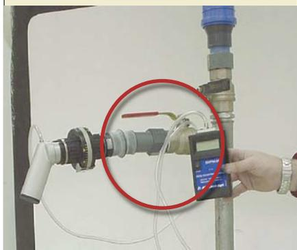
El diámetro interno de la pieza de conexión debe ser el mismo que el de la conducción de aire, o bien de 48,5 mm si el diámetro de la conducción de aire supera ese valor.
