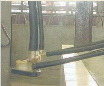
Figura 24b. Colector más elevado que el extremo del manguito. Colocación incorrecta.
