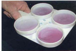
5. Haga movimientos rotatorios con la paleta en forma horizontal para mezclar la solución. La mejor forma de examinar los resultados es después de 10 segundos de agitación; después de ese tiempo, la reacción puede desaparecer.
