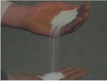
Parte del amoníaco producido se transforma en ácido nítrico, que reacciona con más amoníaco para producir el nitrato amónico. En la fase final, el nitrato amónico fundido se convierte en gránulos sólidos al atravesar la torre de solidificación. Esos gránulos se venden como fertilizante.
