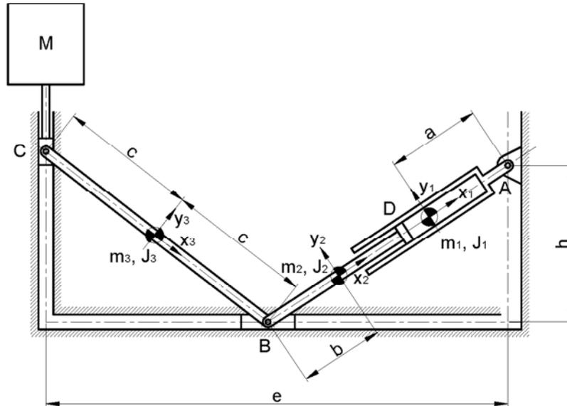
El mecanismo elevador de la figura está formado por tres cuerpos. Los cuerpos 1 y 2 constituyen la camisa y el émbolo de un cilindro hidráulico de sección  $S$  y presión interior  $P$ . El cuerpo 1 está articulado a un punto fijo  $A$ . El cuerpo 2 está articulado al cuerpo 3 en el punto  $B$ . El punto  $B$  se mueve longitudinalmente según la dirección horizontal. El punto  $C$ , perteneciente al cuerpo 3, se mueve verticalmente.
