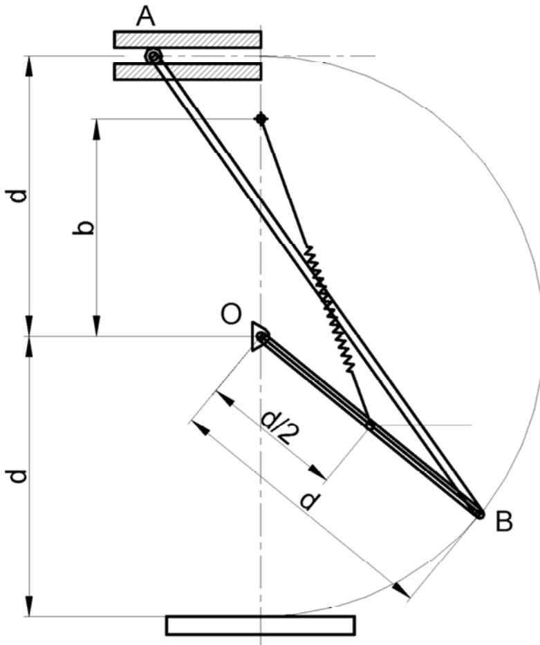
La puerta uniforme AB de un garaje, representada en sección en la figura, tiene una masa  $M$  y está equipada con un mecanismo de resorte como el indicado. El brazo OB tiene masa  $m$  y la esquina superior de la puerta puede deslizarse libremente en dirección horizontal mediante un rodillo.
