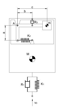
El modelo de la figura constituye un acelerómetro formado por un cuerpo de masa M que en su interior tiene un balancín que gira alrededor del punto A con una masa m concentrada en su extremo. El balancín está sujeto a la carcasa mediante un muelle y un amortiguador según puede verse.
