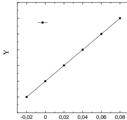
2. Se ha ensayado mecánicamente un material cerámico de alúmina ( $\text{Al}_2\text{O}_3$ ). Los datos que se dan a continuación corresponden a los valores experimentales del esfuerzo de tracción ( $\sigma$ ), medido en GPa, frente a la deformación ( $\epsilon$ ), expresada en tanto por uno.
