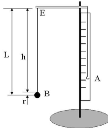
La longitud  $L$  del péndulo es la distancia entre el eje de oscilación  $E$  y el centro de masas de la bola. Es decir, la suma de la longitud de hilo ( $h$ ) y el radio de la bola ( $r$ ).
