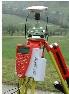
Figure 8: Récepteur GPS fixe
