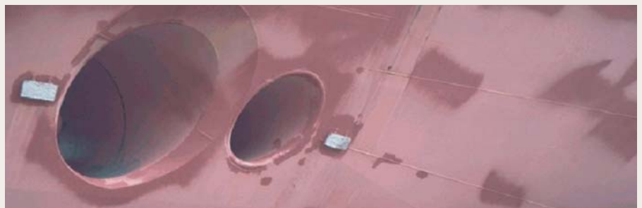
Figura 8. Izquierda y abajo: transductores de las ecosondas multihaz instalados en el B/O Hespérides
