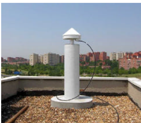
Ejemplo de estación permanente GPS
