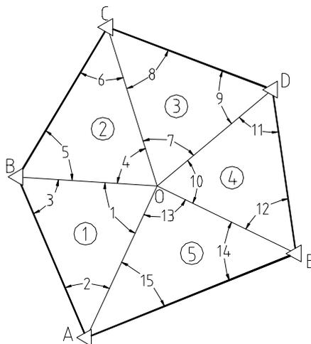
Aplicando el teorema de los senos a los diferentes triángulos obtenemos en el triángulo 1:
