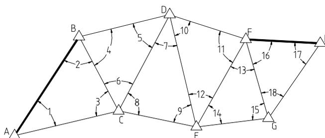
Llamaremos cadena a la disposición de triángulos que tienen una base en común entre triángulos y no existe ningún vértice en común a todos ellos.
