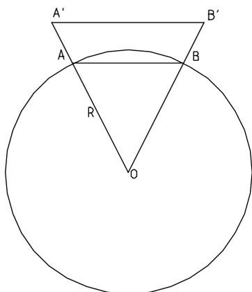
Las longitudes medidas han de experimentar diversas correcciones, siendo la primera la correspondiente a su *reducción al horizonte*, si es que el sistema empleado para obtenerla no da directamente este tipo de distancias.
