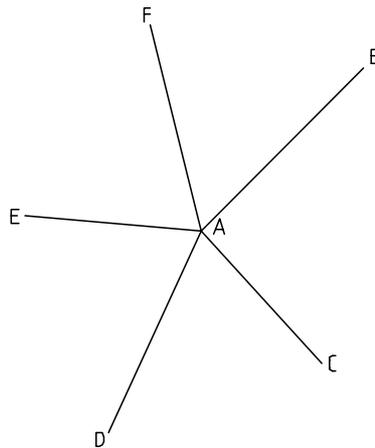
Con todas las observaciones obtenidas angulares y de distancias, puede realizarse el cálculo de las coordenadas de los vértices planteando las ecuaciones de observación que corresponden al modelo.
