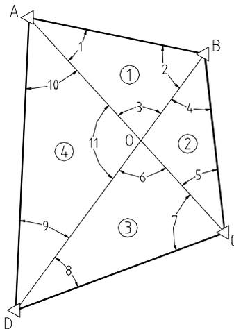
**1º Compensación:** Suma de ángulos en triángulos opuestos.
