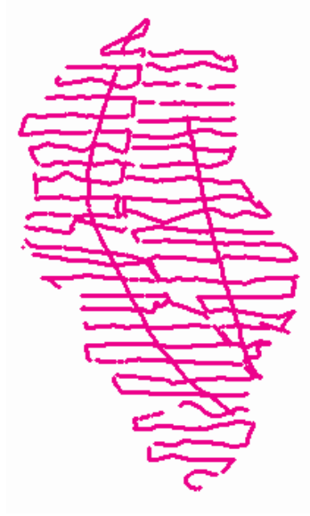
Fig.1 Ejemplo de la ruta de navegación de la embarcación en un levantamiento batimétrico
