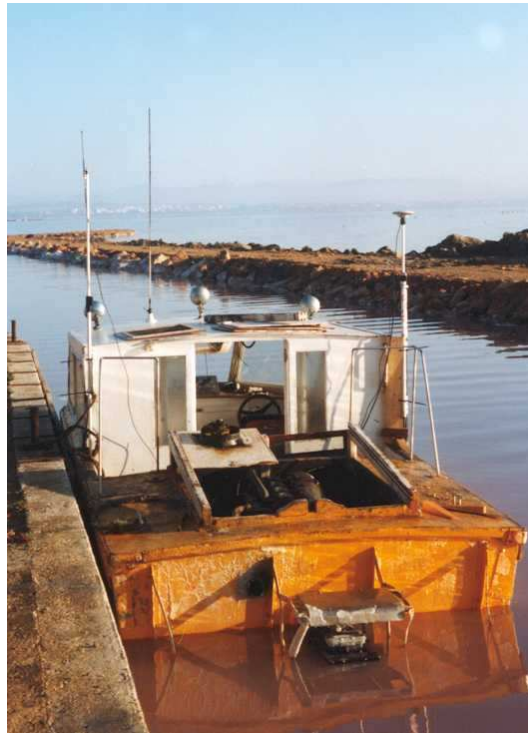
Fig. 22 La antena GPS a estribor, antena Radio-Módem a babor.
