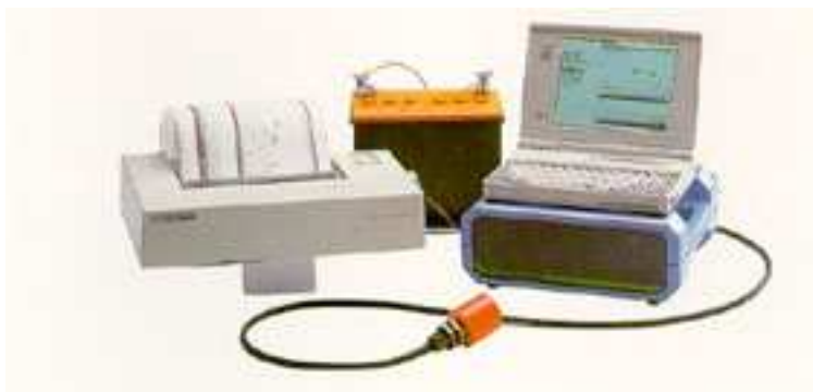
Fig. 6 Equipo Ecosonda completo: sensor, transductor, impresora, PC y batería
